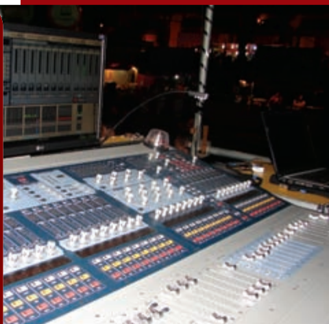
A Avid Digidesign Venue Profile instalada na Housemix do Pedrão 2010 para controle do sistema de PA Norton. A escolha do console aconteceu por meio de uma pesquisa com os técnicos que atuariam no festival, buscando saber com qual produto eles se sentiam mais confortáveis
